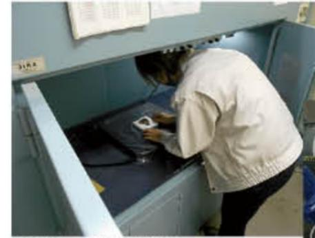
金属製品のX線透過検査
