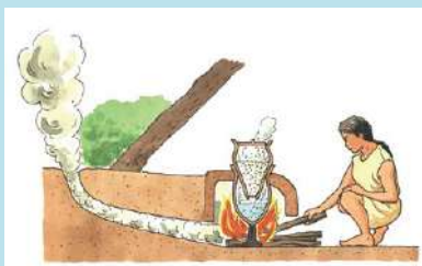
カマドの仕組み（復元図）
