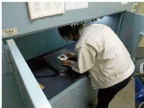
金属製品のX線透過検査
